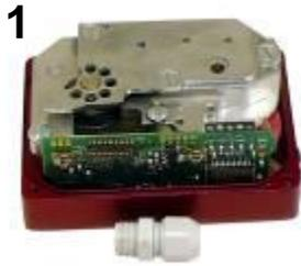
1.- Retirer le raccord étanche aux liquides du boîtier de l'actuateur et y insérer le câble.
