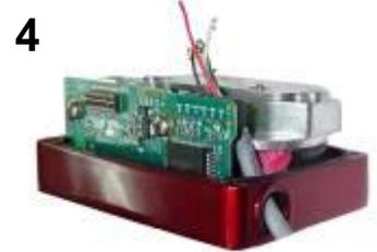
4.- Insérer soigneusement le câble dans la base de l'actuateur. Attention au câble rouge du moteur et à sa fiche dans la carte. Le déplacement de la fiche de sa position complètement insérée peut provoquer un dysfonctionnement de l'actuateur.
