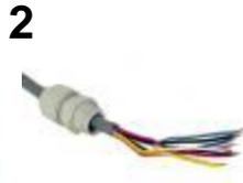
2.- Le câble doit être retiré de sa veste pour 2 po. (50mm) et les fils ont besoin les extrémités d'être dénudées à 1/8 po. (3mm).
