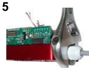
5.- Remettre le raccord étanche aux liquides et serrer (légèrement avec un outil).
